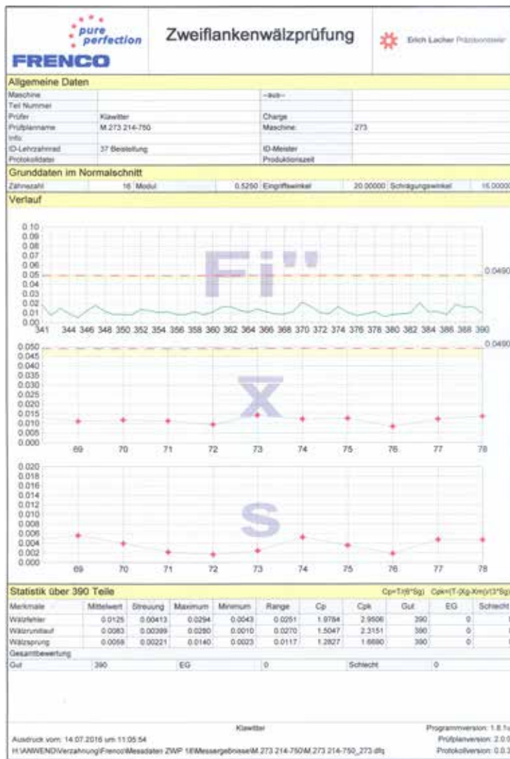
Die Zweiflankenwälzprüfung ist ein effizientes Hilfsmittel zur genauen Beurteilung der Qualität des Werkstücks.
