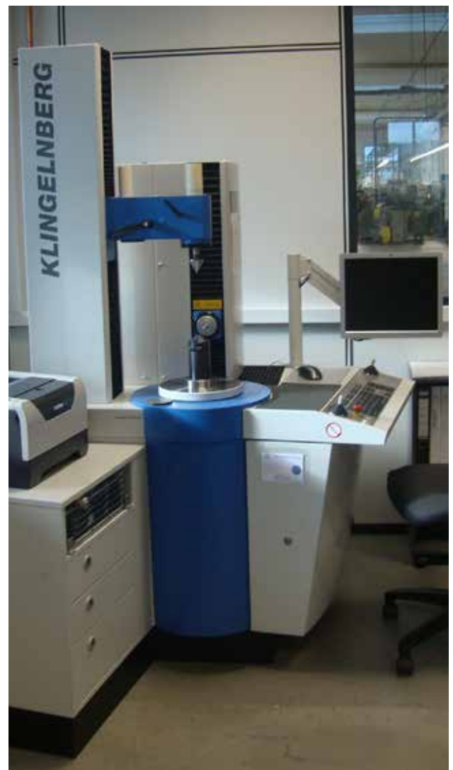
Fertigungsbegleitend werden die Zahnräder / Ritzel und Schnecken auf einem vollautomatischen CNC-gesteuerten Verzahnungsmesszentrum geprüft.
